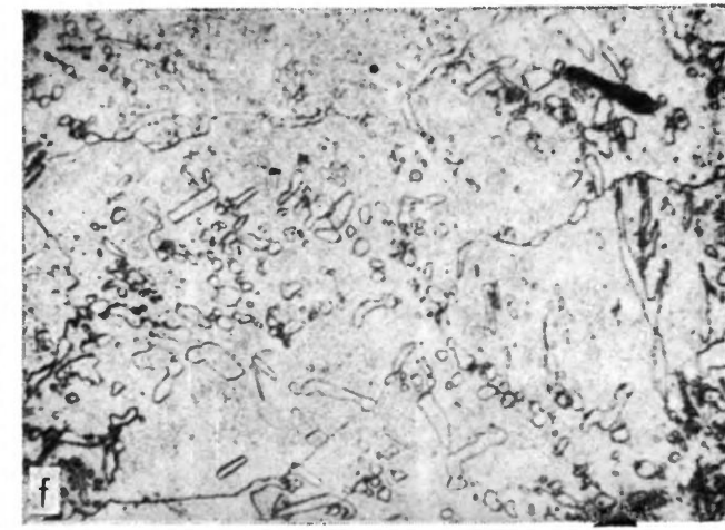
Ryc. 4. Mikrostruktury miecza z Krasuszy — Gołowierzchów (cyfry w nawiasach określają miejsca obserwacji mikroskopowych zaznaczone na ryc. 2a); a — ostrze miecza (1), ferryt+perlit, pow. 75 X; b — ostrze miecza (2), ferryt+perlit, widoczna degeneracja płytek cementytu w perlitcie, pow. 300 X; c — gruboziarnista warstewka żelaza fosforowego w paśmie dziweru (3), pow. 150 X; d — fragment pasma dziweru (4), widoczna warstewka żelaza i stali, pow. 75 X; e — część środkowa miecza (5), obszar ferrytu i perlitu zdegenerowanego, pow. 300 X; f — część środkowa miecza (6), obszar ferrytu i cementytu skoagulowanego, pow. 750 X
