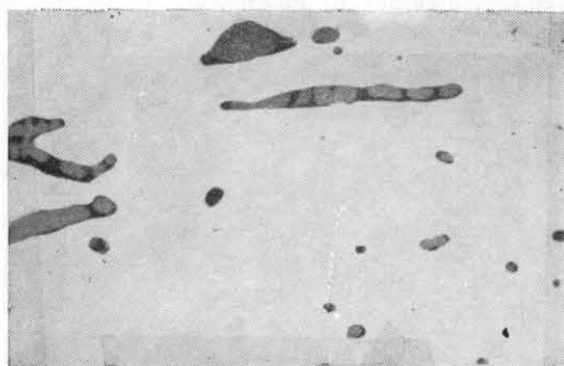
Ryc. 16. Fragment nr 5. Struktura (a, b). Wtrącenia żuźla w próbce nietrawionej (c). Powiększenia: 100×(a, b), 500×(c)
