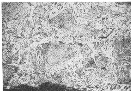
Ryc. 20. Nóż nr 8. Struktura. Powiększenie 100×
