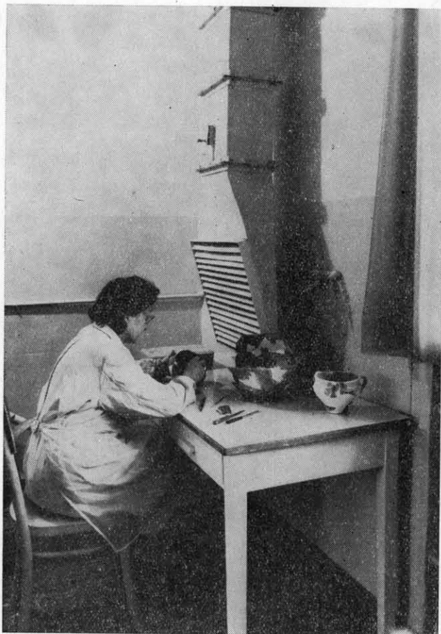
Ryc. 4. Państwowe Muzeum Archeologiczne w Warszawie. Specjalny wyciąg do usuwania pyłu powstającego przy zabiegach konserwatorskich
